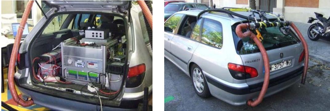
Figura 2- Sistema de medida de emisiones contaminantes – MIVECO-PEMS
