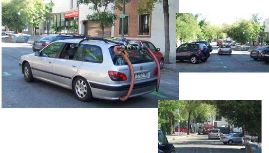
Figura 12- Pruebas en tráfico real del equipo MIVECO-PEMS.
