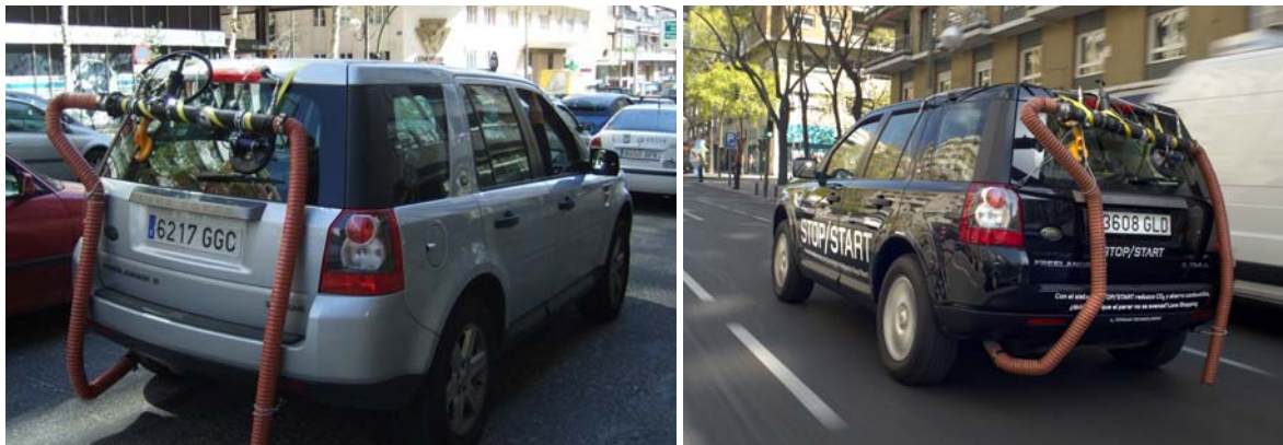
Fig. 3 – Fotografías de los Land Rover FREELANDER2 9MY y 10MY durante los ensayos en la ciudad de Madrid.
