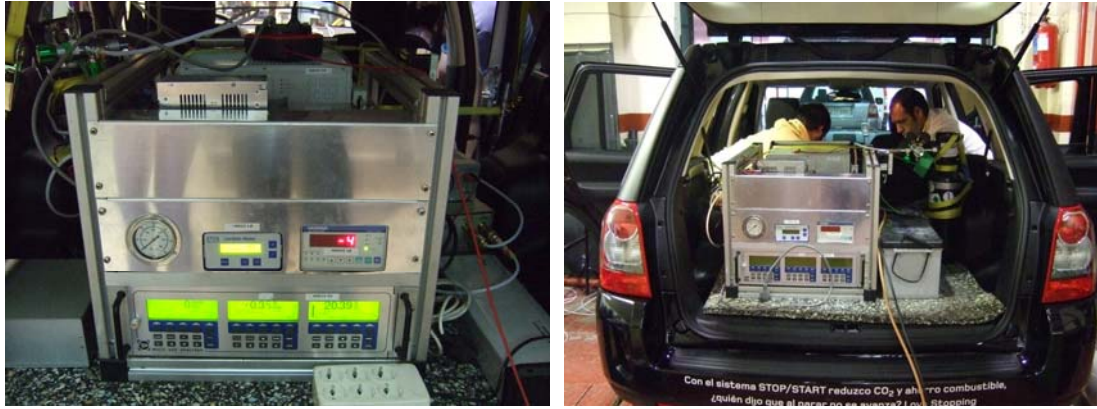
Fig. 4 – Equipos de medida instalados en los vehículos
