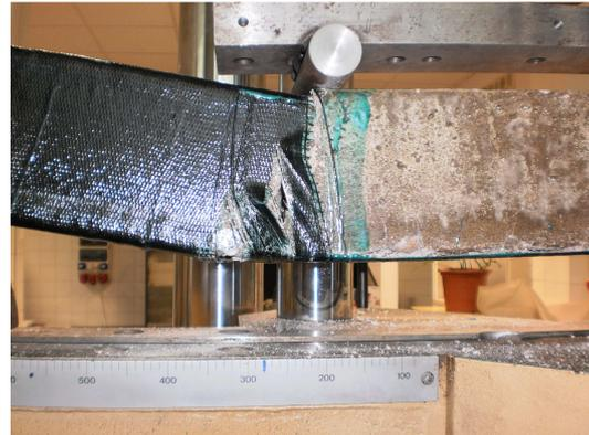
Fig. 1: Detalle de una viga reforzada y ensayada hasta rotura.
