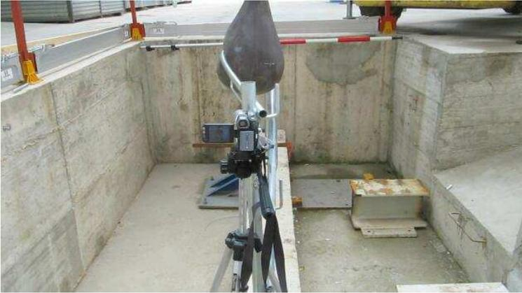
Figura 5. Máximo desplazamiento de la barandilla de S1 en el momento del impacto
