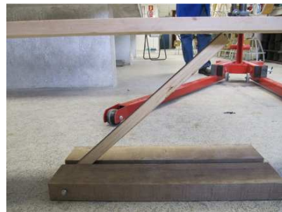
Figura 3 – Falsa escuadra debajo de la tabla ensayada
