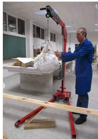
Figura 4 – Ensayo de impacto con E = 180 J
