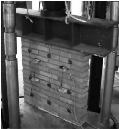
Figura 4. Ensayo de compresión de un muro.
