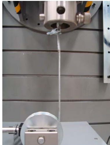
Figura 14 - Fijación y ajuste del cable con el hidráulico del bastidor 4
