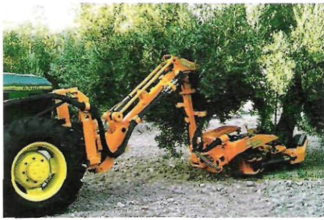
Figura 5. Vibrador frontal articulado montado sobre tractor. Fuente: Catálogo Pellenc.
