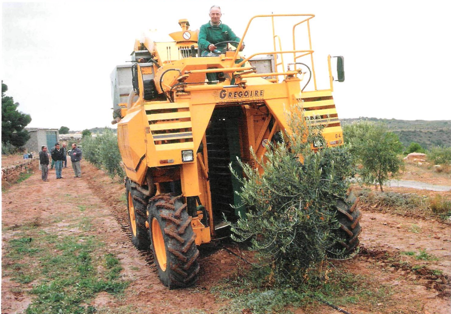
Figura 4. Vendimiadora adaptada para la recolección de aceituna en olivar superintensivo.
