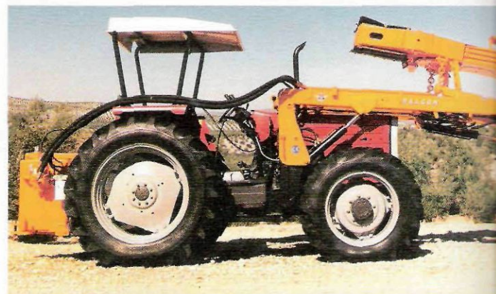
Figura 1. Vibrador de troncos montado sobre tractor, abatido para el transporte. Fuente: Catálogo Halcón.
