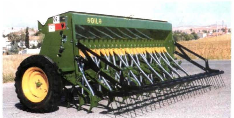
Foto 2. Sembradora a chorrillo con elementos dosificadores individualizados para cada línea de siembra.
