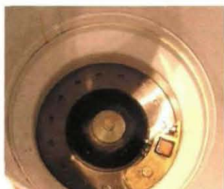
Foto 9. Plato dosificador horizontal de sembradora mecánica monograno.
