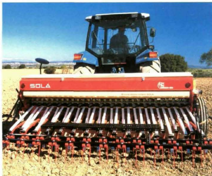
Foto 7. Sistema de cobertura con grada en sembradora a chorrillo.
