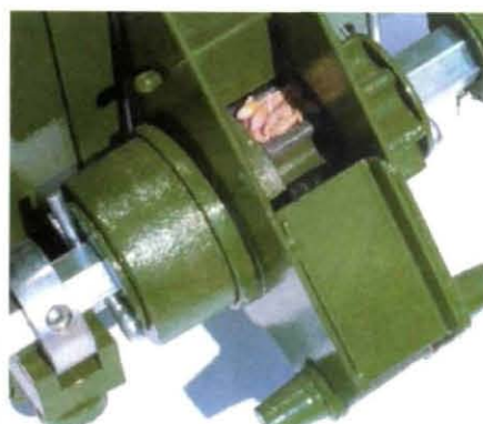
De izquierda a derecha. Foto 4. Eje de dosificadores individualizados de doble dentado para sembradora a chorrillo mecánica. Foto 5. Detalle dosificador de rueda dentada. Documentación Gil. Foto 6. Dosificador de sembradora a chorrillo neumática. Documentación Amazone.
