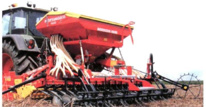
Foto 3. Sembradora a chorrillo neumática con elemento dosificador centralizado.
