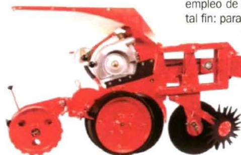
Foto 12. Cuerpo de siembra de una sembradora neumática monograno con limpiador de residuos estrellado y cuchilla circular previos a los discos abridores del surco.
