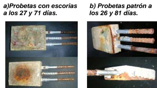
Figura 6. Manchas de óxido en las dosificaciones MCE y MCC y 2% de ión cloruro en peso de cemento.
