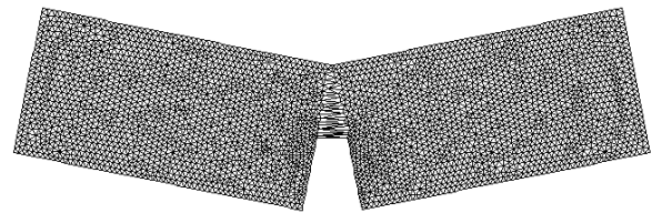
Figura 9. Malla de elementos finitos deformada correspondiente a la simulación del panel 10 – 50 – 10.
