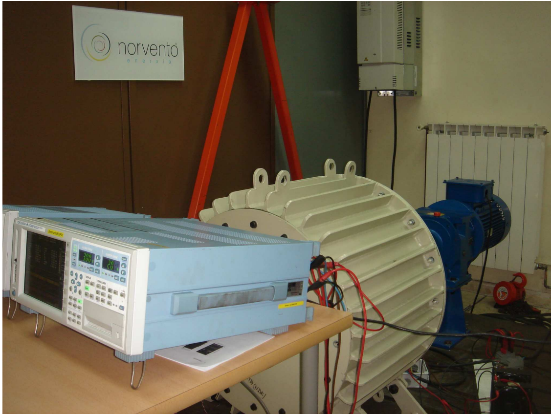
Figura 63. Fotografía del prototipo construido en el banco de ensayos configurado para las pruebas. En azul el motorreductor de arrastre, en blanco la máquina de imanes permanentes.
