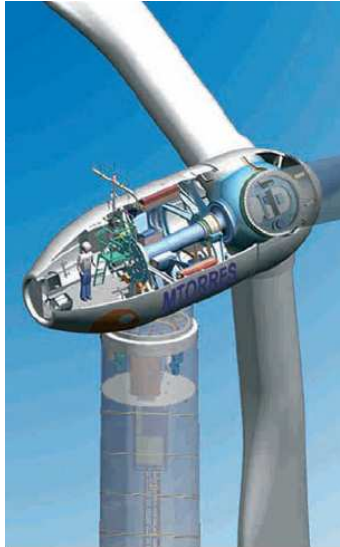
Figura 6. Vista seccionada de la máquina de accionamiento directo de la empresa M.Torres, obtenida en www.mtorres.es .
