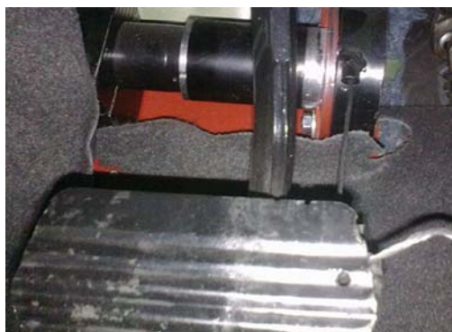
Figura 5: Montaje para la actuación sobre el pedal de freno.
