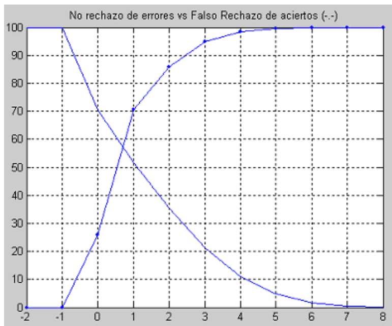
Figura 4.27. Barrido de umbrales del logaritmo de la energía normalizada para DEV_GSM_COACHE con SNR=15dB. Errores de falso rechazo (línea punteada) y falsas aceptaciones (línea continua).
