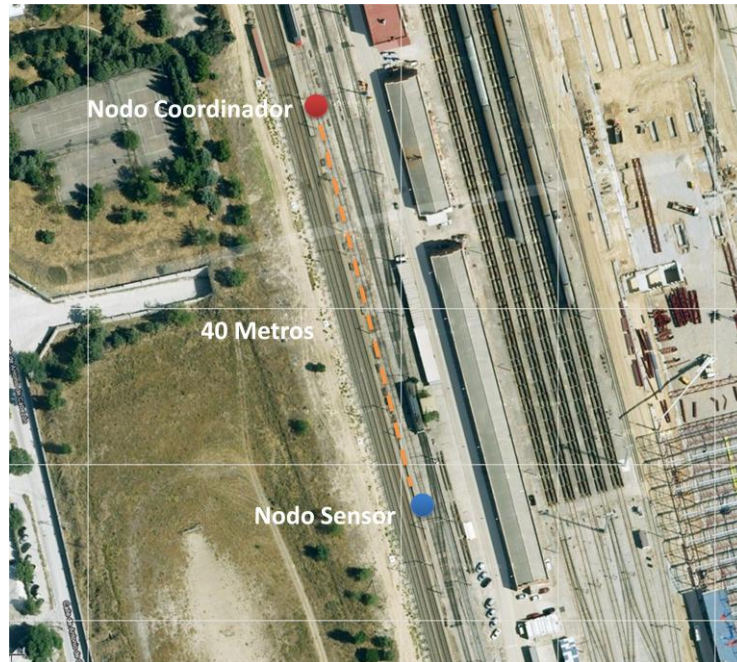
Figura 5.2: Pruebas de alcance del módulo de comunicaciones Zigbit.
