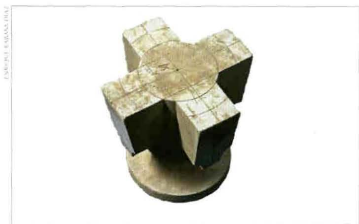
Fig. 21 / Clave de la maqueta de bóveda de crucería cuatripartita
