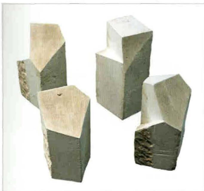
Fig. 6 / Piezas de yeso para la confección de la maqueta de bóveda de arista
