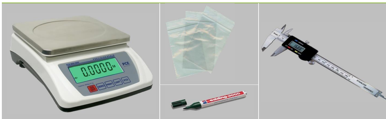
Figura 3.15. Material utilizado en la preparación de las semillas: báscula digital modelo PCE bsh.1000 (izquierda arriba), calibre digital marca Rebalng (derecha), rotulador indeleble negro y bolsas de plástico (centro).
