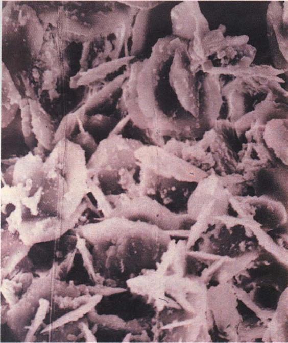
*Fotomicrografía al Microscópio Electrónico de Barrido de sales (sulfatos y cloruros) producidos por la contaminación en el material pétreo. Edificio del Ministerio de Hacienda de la calle Alcalá de Madrid.*
