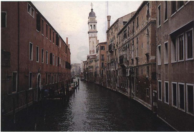
*La acción del agua y la presencia de humedales genera, bajo determinadas condiciones geológicas y litológicas del sustrato, asentamientos diferenciales que ocasionan el desplazamiento de las estructuras de los edificios, tal y como se puede observar en la torre de esta iglesia veneciana.*
