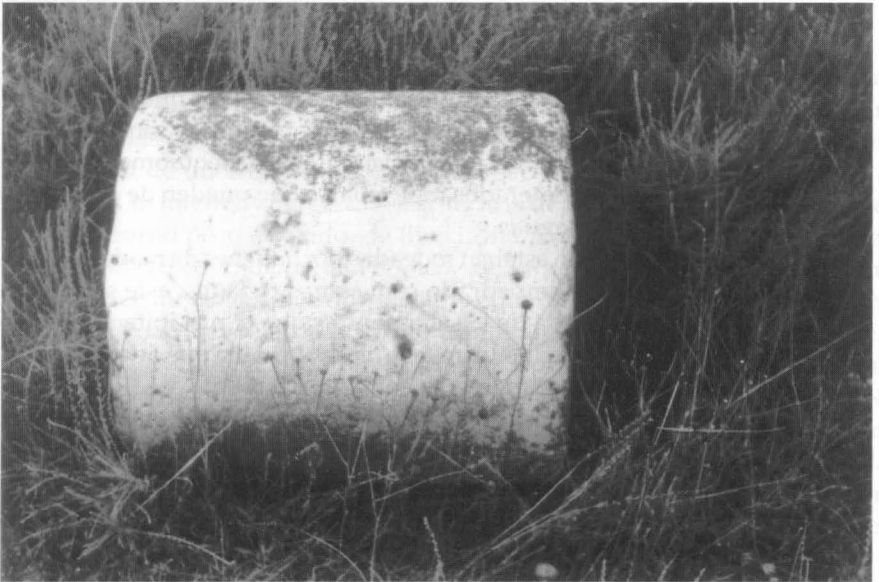
Fig. 8 – Rulo para preparar el fondo de las balsas. Foto de los autores.
