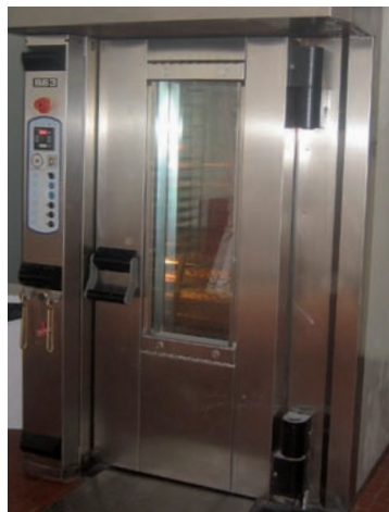
I prodotti vengono cotti nel forno industriale rotativo.
