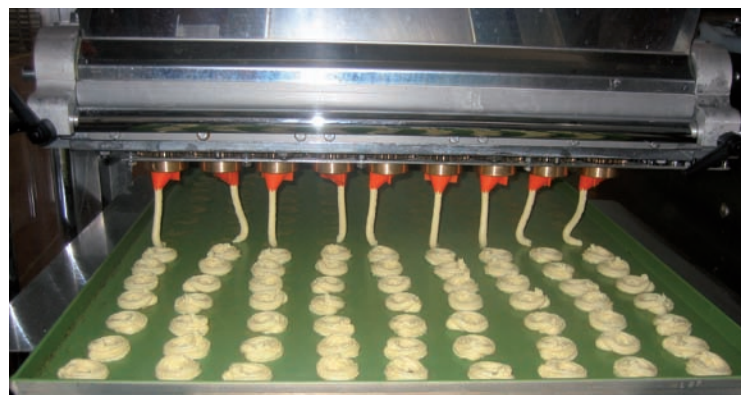
Preparazione dei frollini mediante macchina colatrice.
