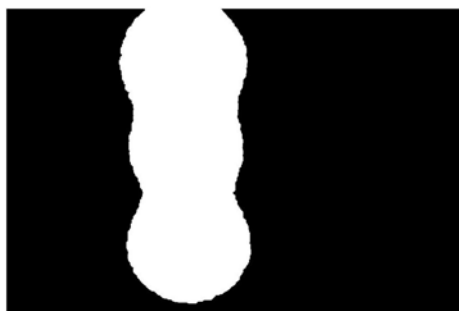
Figura 5: Imagen global del área iluminada por los tres LED al aplicar el nivel de segmentación 2
