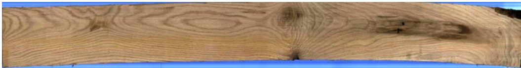
Fig. 4.8. Imagen de un tablero captado con una cámara de color del tipo 'line-scan'.
