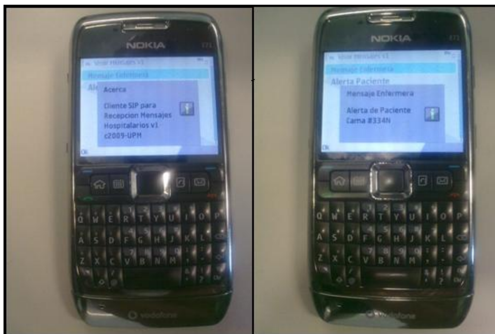
Figura 14. Integración Cliente SIP en Teléfono Móvil
