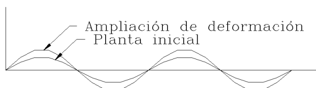
Fig. 3.6 Ampliación de imperfecciones
