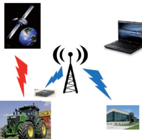
Con il JDLink è possibile visualizzare fino a 34 variabili di funzionamento del motore.
