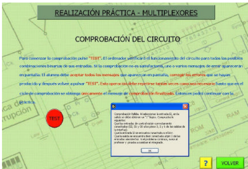
Figura 4. Comprobación fallida de un circuito. Se observa la ventana de orientación sobre el fallo.
