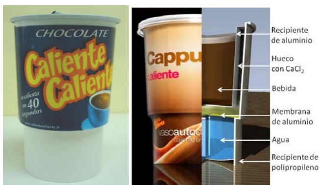
Figura 1. Vaso autocalentable por disolución de \text{CaCl}_2 en agua.
