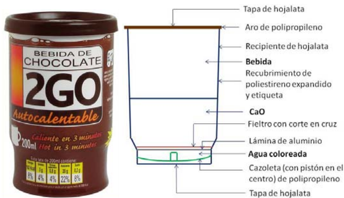
Figura 2. Vaso autocalentable por reacción de cal (CaO) con agua.
