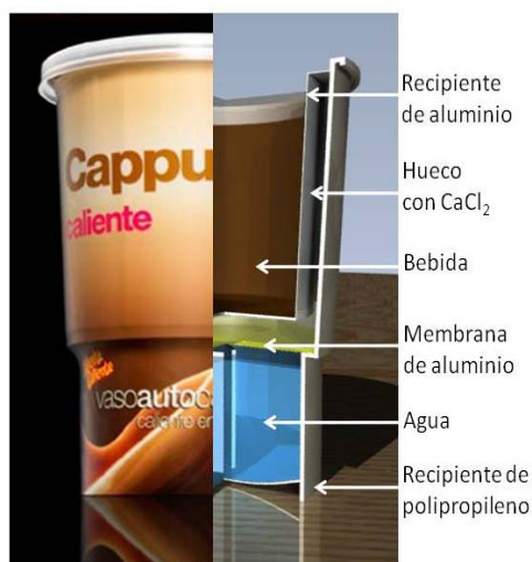
Figura 4: Dibujo realizado por alumnos de primer curso de Ingeniería Industrial sobre otro modelo de envase de bebida autocalentable.
