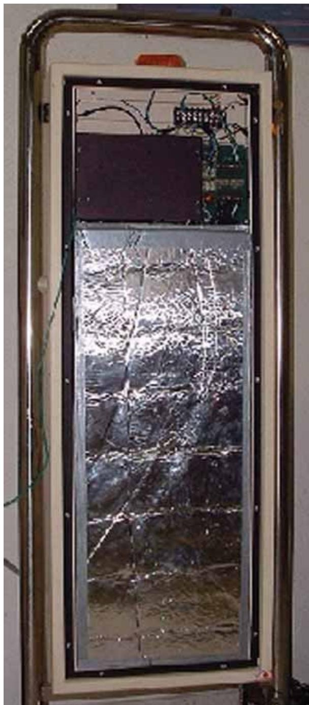
**FIGURA 3.** Sistema de detección GR-606 de Exploranium. El interior está provisto de un detector de grandes dimensiones de PVT con su electrónica asociada.
