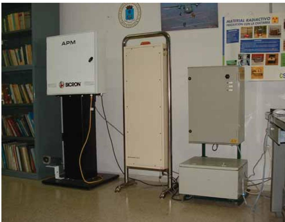
**FIGURA 1.** Equipos analizados: APM de Bicron (izquierda), GR-606 de Exploranium (centro) y FHT-1372 de Thermo Eberline (derecha).
