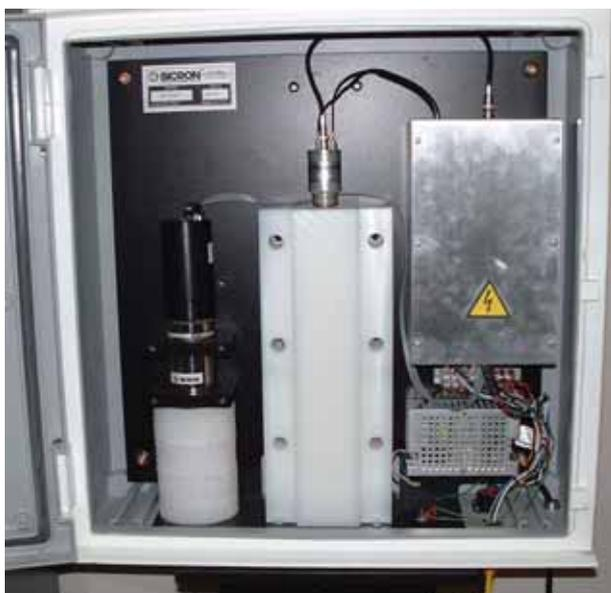
**FIGURA 2.** Sistema de detección APM de Bicron. En su interior se observa el detector de NaI(Tl) y la electrónica asociada.
