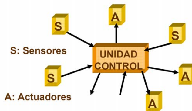
Fig. 1: Topología de un sistema centralizado.
