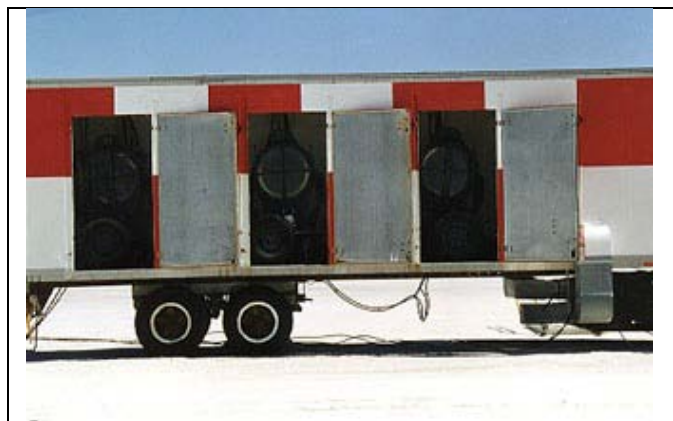
Figura 13.- Uno de los dos tráiler con tres proyectores de Xenon utilizados para el apoyo al aterrizaje nocturno de los Space Shuttle. NASA.
