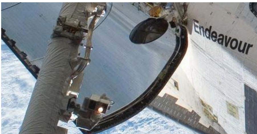
Figura 11. - Extremo del brazo robot con la luz y la cámara para su manejo. NASA.
