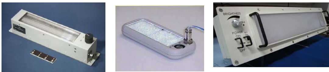
Figura 10.- (a) Luminaria estanca utilizada en los paneles derecho e izquierdo de la cabina de pilotos del vehículo orbital, con dos lámparas fluorescentes, variación de brillo utilizando el mando rotatorio y difusor de policarbonato. Peso aproximado 1'2 kg. (b) Prototipo de luminaria con LED's. (c) Luminaria estanca con dos fluorescentes e interruptor de on-off y botón de regulación de brillo, con difusor de policarbonato.
