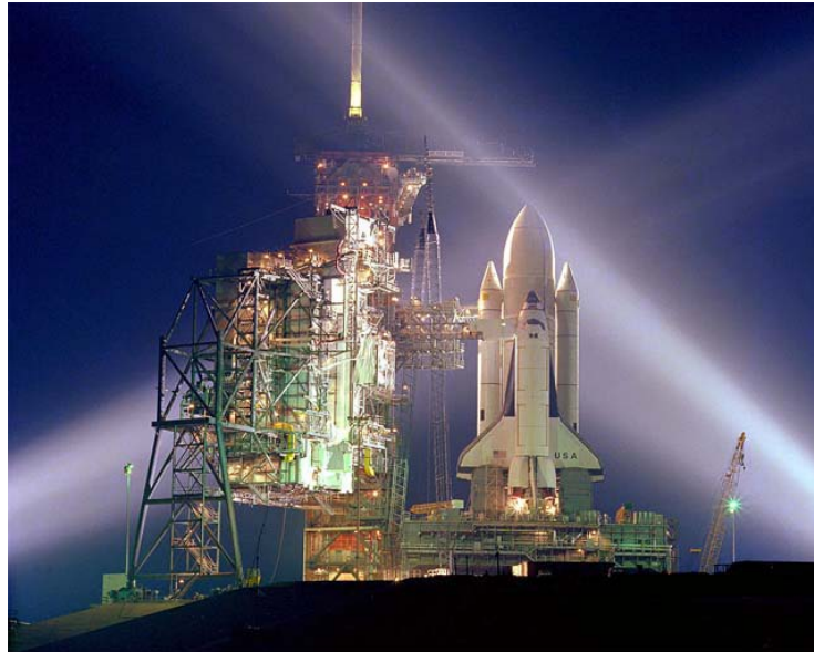
Figura 1.- Space Shuttle en la plataforma de despegue. Los dos cilindros más pequeños adosados a los laterales del cilindro más grande, depósito de propulsante líquido, son los cohetes de propulsante sólido. NASA
