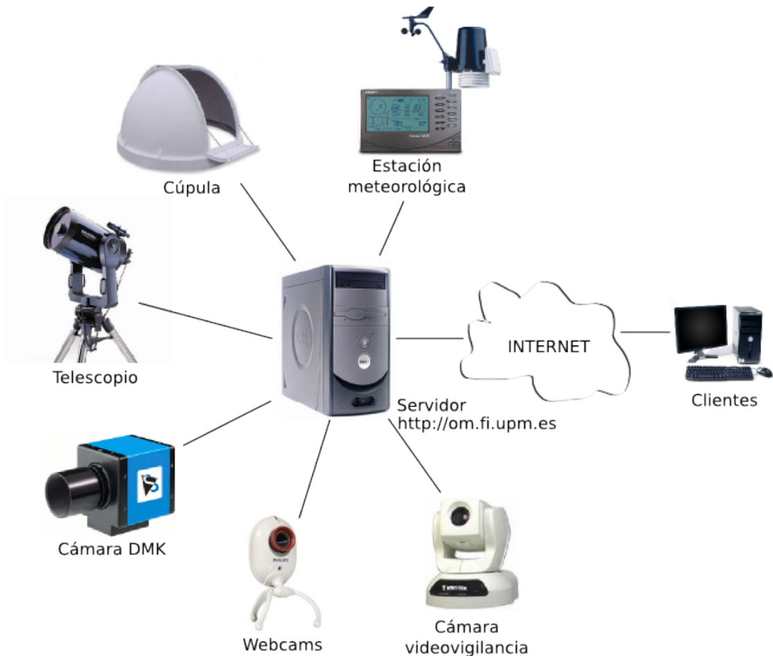
Figura 3.12: Arquitectura del escenario del observatorio Montegancedo. Se compone de un ordenador servidor conectado a Internet, el cual se comunica y controla todos y cada uno de los dispositivos.
