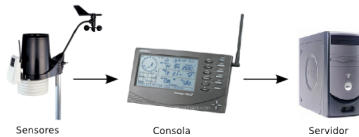
Figura 3.17: Comunicación entre los sensores y la consola de la estación meteorológica y el servidor
