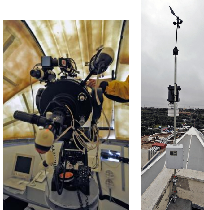
Figura 3.10: Izquierda, montura, telescopios y cámaras; derecha, estación meteorológica y cámara IP
