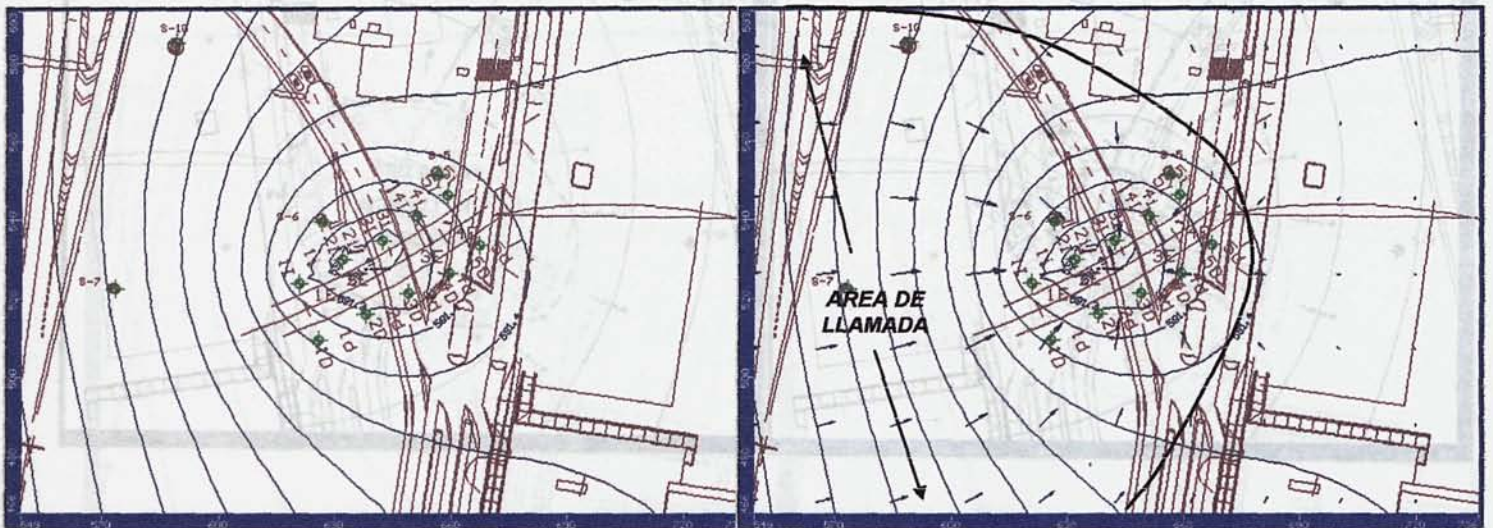
Fig. VII.24: Piezometría y área de llamada de bombeo en el segundo periodo de bombeo (noviembre 1998)
