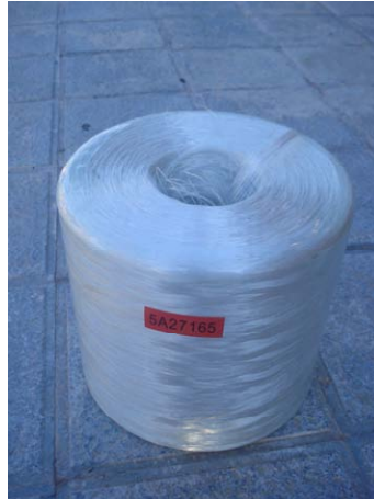
Fotografía 1: Bobina de fibra de vidrio (spray roving). (Gentileza de PROQUINSA)
