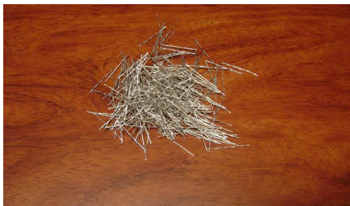
Fotografía 2: Fibra metálica de acero conformada.
