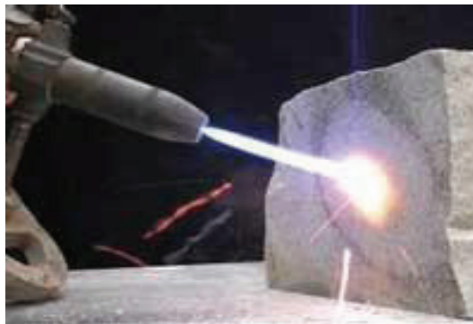
Figura 4. Espalación por llama. (Fuente: Spallation Drilling for Deep Heat Mining . July 2, 2007. Tobias Rothenfluh. Karol Príkopský. Philipp Rudolf von Rohr. ETH).
