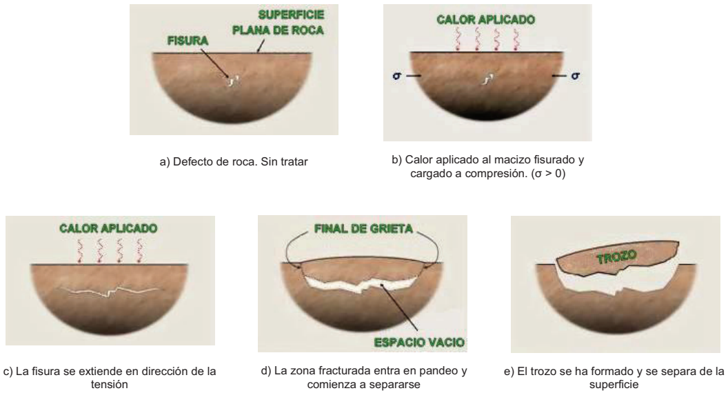
Figura 5. Esquema de la tecnología de espalación (Fuente: http://www.potterdrilling.com . Modificado por el autor).
