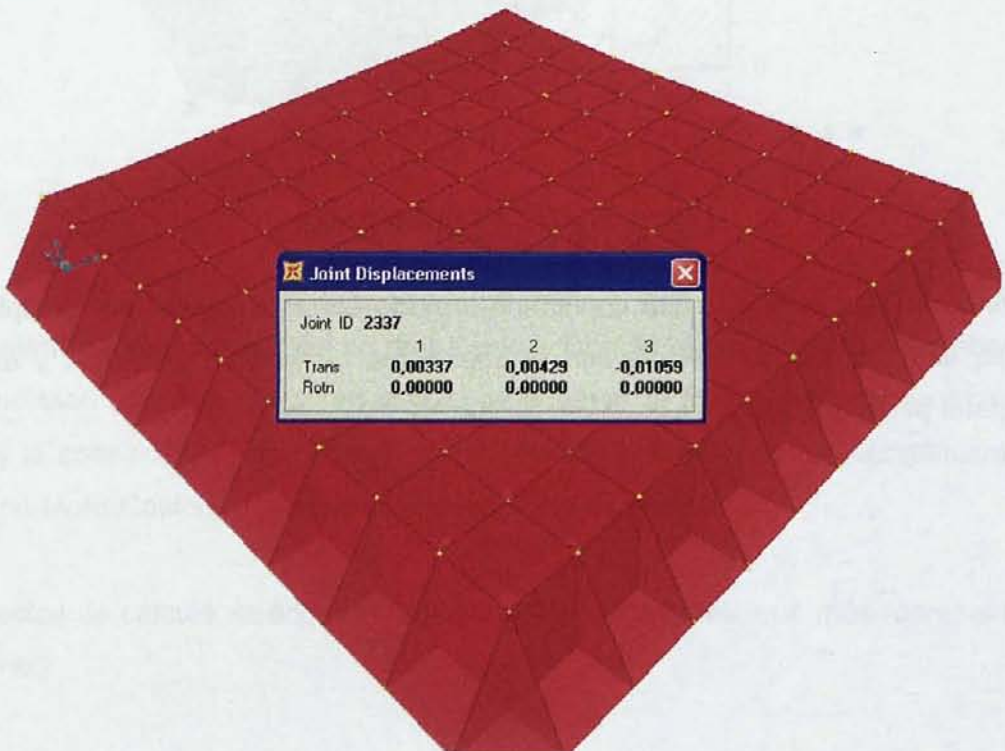
Figura 11. Deformaciones del terraplén de prueba
