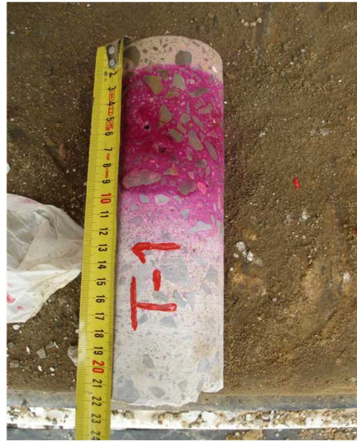
Figura 1.4 Probeta de hormigón carbonatado.
