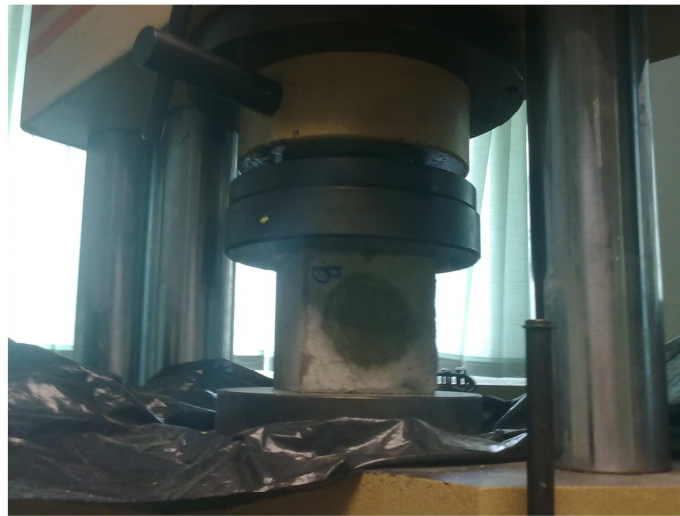
Figura 3.8 Probeta cúbica de hormigón colocada en plato de descarga.
