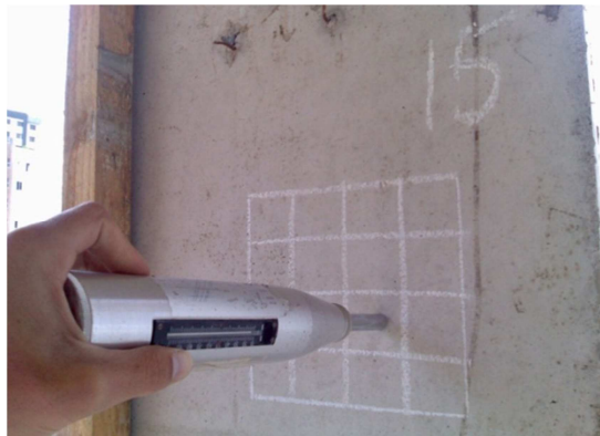
Figura 1.1 Martillo de Schmidt aplicado sobre superficie de hormigón.
