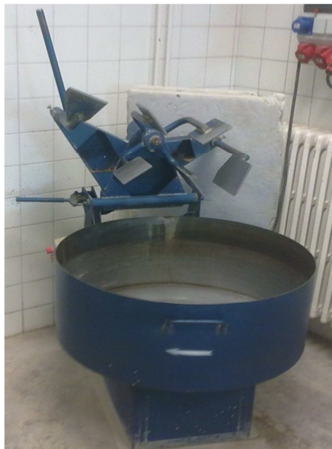
Figura 3.1 Hormigonera planetaria, con la que se ha realizado el hormigón.
