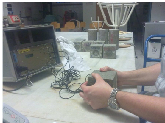
Figura 3.6 Ejemplo de medida de la velocidad de ultrasonidos en las caras opuestas de una probeta.
