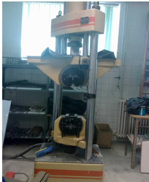
Figura 3.7 Máquina universal de ensayos Ibertest, modelo MIB-60/AM, empleada en la rotura a compresión.
