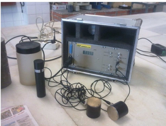
Figura 3.5 Equipo de medición de ultrasonidos empleado.
