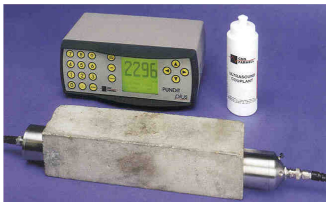
Figura 2.9 Equipo genérico de medida mediante ultrasonidos, junto con un envase que contiene vaselina.
