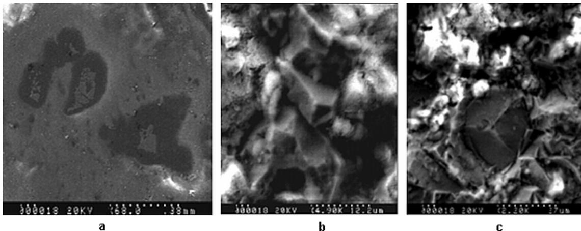
Figura 5: Microfotografías obtenidas por escáner electrónico mostrando partículas de oro (5 a) en cavidades formadas por lixiviación de la *diorita-microdiorita*, así como cristales de pirita y arsenopirita (5 b y c) de origen hidrotermal metasomático.
