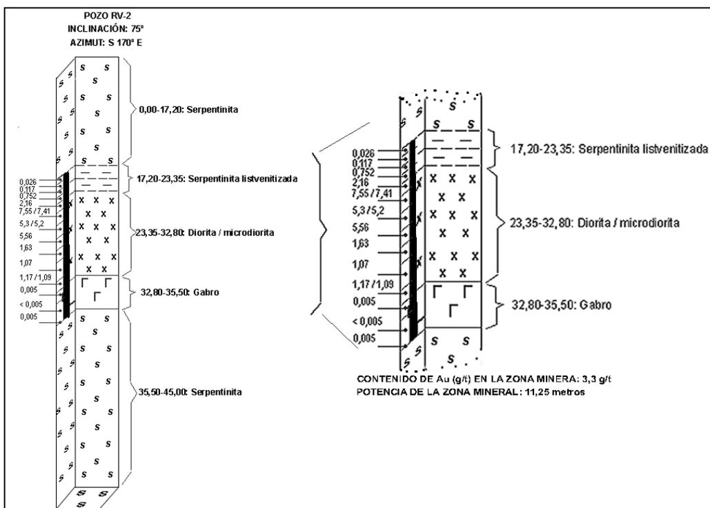
Figura 3: Bloques tridimensionales representando la yacencia de las formaciones litológicas en el flanco oriental del yacimiento Reina Victoria, de acuerdo con los datos del sondeo *RV-2*. Se muestran, además, los intervalos mineralizados y las zonas de muestreos.
