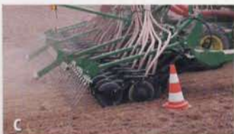
Tractor y sembradora equipados con iGuide (a). El cono delimita el lugar por donde tiene que pasar el implemento. En el detalle se aprecia la precisión de la pasada realizada con iGuide (b). Pasada sin iGuide (c).
