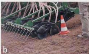
Tractor y sembradora equipados con iGuide (a). El cono delimita el lugar por donde tiene que pasar el implemento. En el detalle se aprecia la precisión de la pasada realizada con iGuide (b). Pasada sin iGuide (c).
