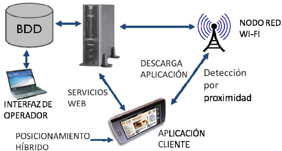
Figura 2: Esquema de la arquitectura del SIVIT
