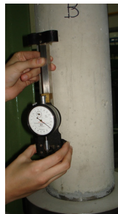
Figura 1. Ensayo de fluencia: a) montaje del ensayo, y b) toma de medidas de las deformaciones de una probeta.
