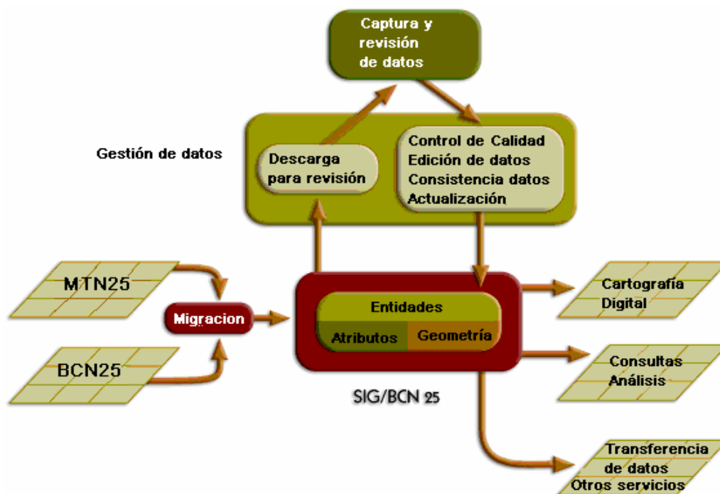
Figura 1. Integración de datos de MTN y BCN en un único Sistema de Información (SIG25/200)
