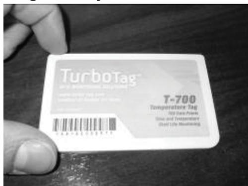
**Tarjetas RFID semipasivas (TurboTag Sealed Air Inc).** Hemos usado tarjetas con tecnología RFID capaces de almacenar hasta 700 datos de Temperatura con una precisión de  $\pm 0.5^{\circ}\text{C}$ . Estas tarjetas del tamaño de una tarjeta de crédito, operan en la banda de los 13.56 MHz y los datos pueden ser transferidos a un PC a través de un receptor conectado vía USB.
