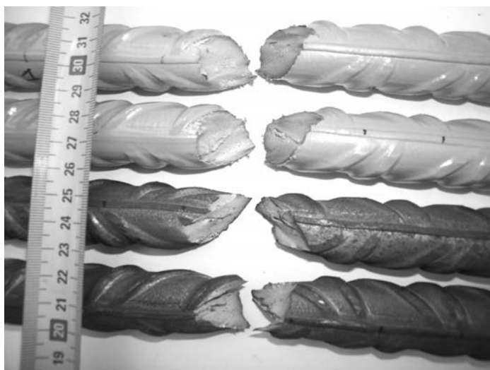
Figura 4. Barras tras el ensayo de tracción
