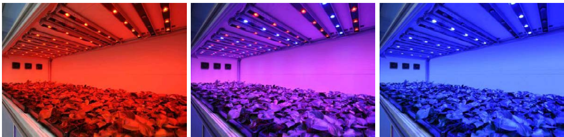
Figura 10. Irradiación de plantas mimética de la fotosíntesis, con luz en las bandas del azul y el rojo (Cortesía de Philips).
