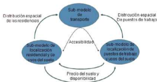
Fig. 2 - Interacción entre el sistema de transporte y los usos del suelo en el modelo MARS
