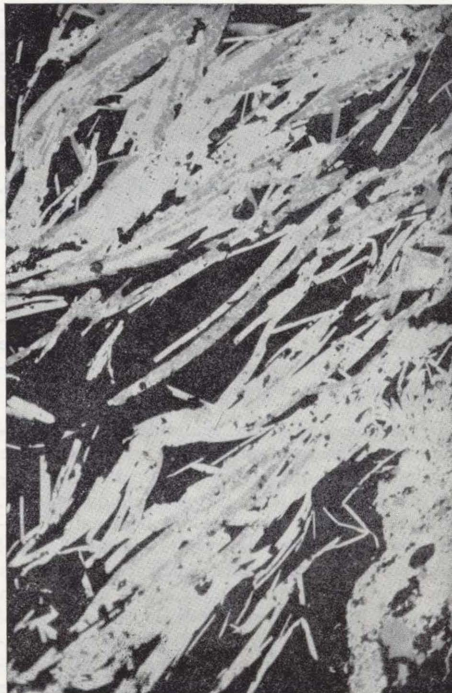
Foto 5.—Cristales de hematites en proceso de magnetización (luz reflejada, aceite, \times 350 , N II).
