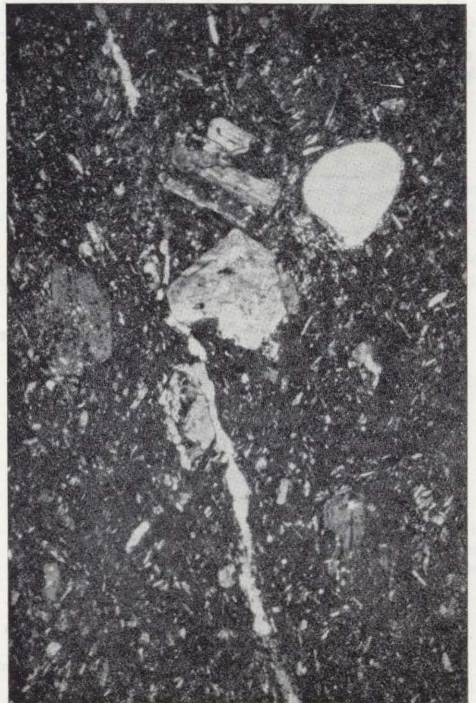
Foto 2.—Fenocristales de plagioclasa y cuarzo en lava dacítica inferior (luz transmitida, \times 36 , N X).
