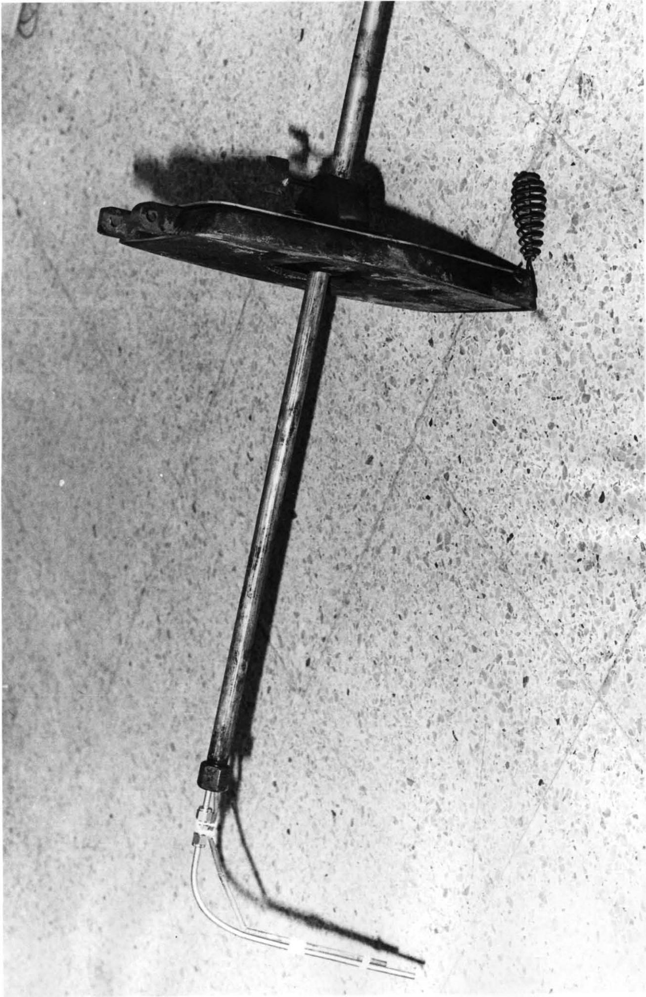
FIG. 5-18 (SONDA DE TOMA DE MUESTRAS Y TEMPERATURAS)
