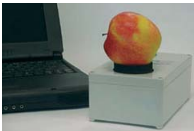
Figura 8: Equipo acústico de sobremesa para la determinación de la firmeza en frutas. Comercializado por la empresa holandesa AWETA
