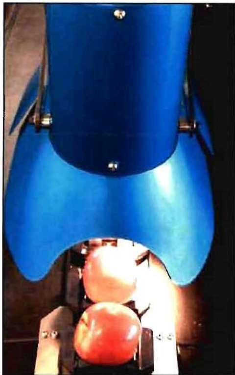
Espectroscopía de reflectancia NIR (infrarrojo cercano) en línea para la estimación de sólidos solubles (azúcares) comercializado por la empresa Compac.
